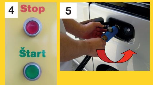
5. K odpojeniu plniacej koncovky od vozidla otočte ručnú páku v protismere hodinových ručičiek o 180°. (Ručnú páčku otáčajte o ¼ otáčky proti smeru hodinových ručičiek do strednej polohy (tlak klesne) a pokračujte ďalej o ¼ otáčky až na doraz, plniaca spojka sa odpojí.) (obr.5)
